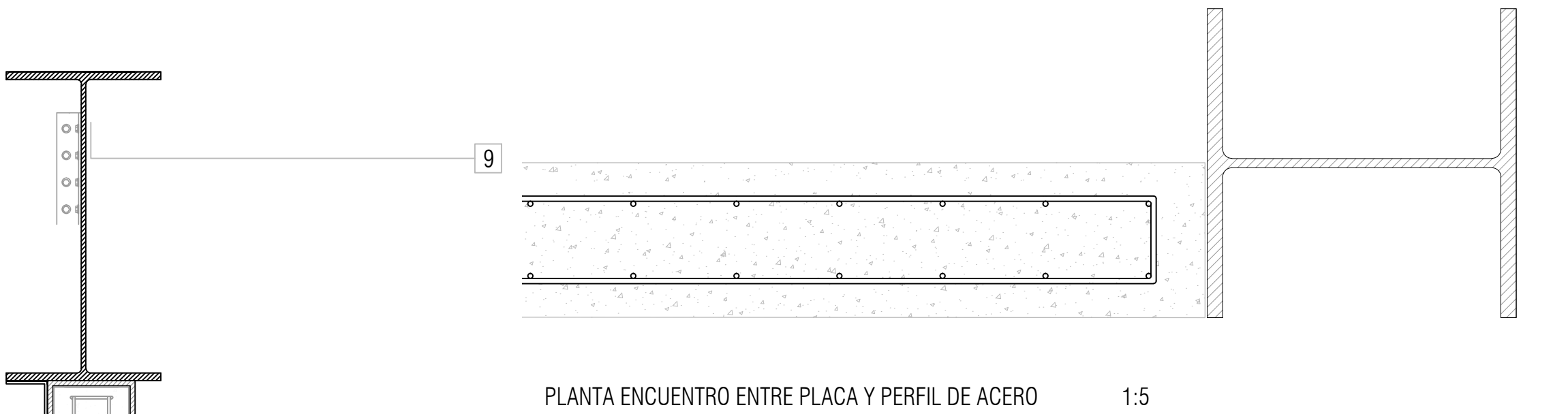
PLANTA ENCUENTRO ENTRE PLACA Y PERFIL DE ACERO 1:5
